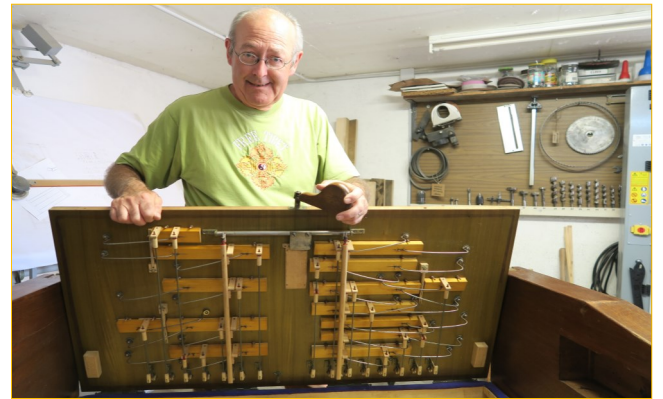
Face inférieure de la mécanique des registres
